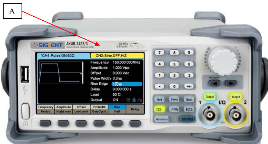
Рисунок 1 - Внешний вид генераторов и место нанесения знака утверждения типа (А)
